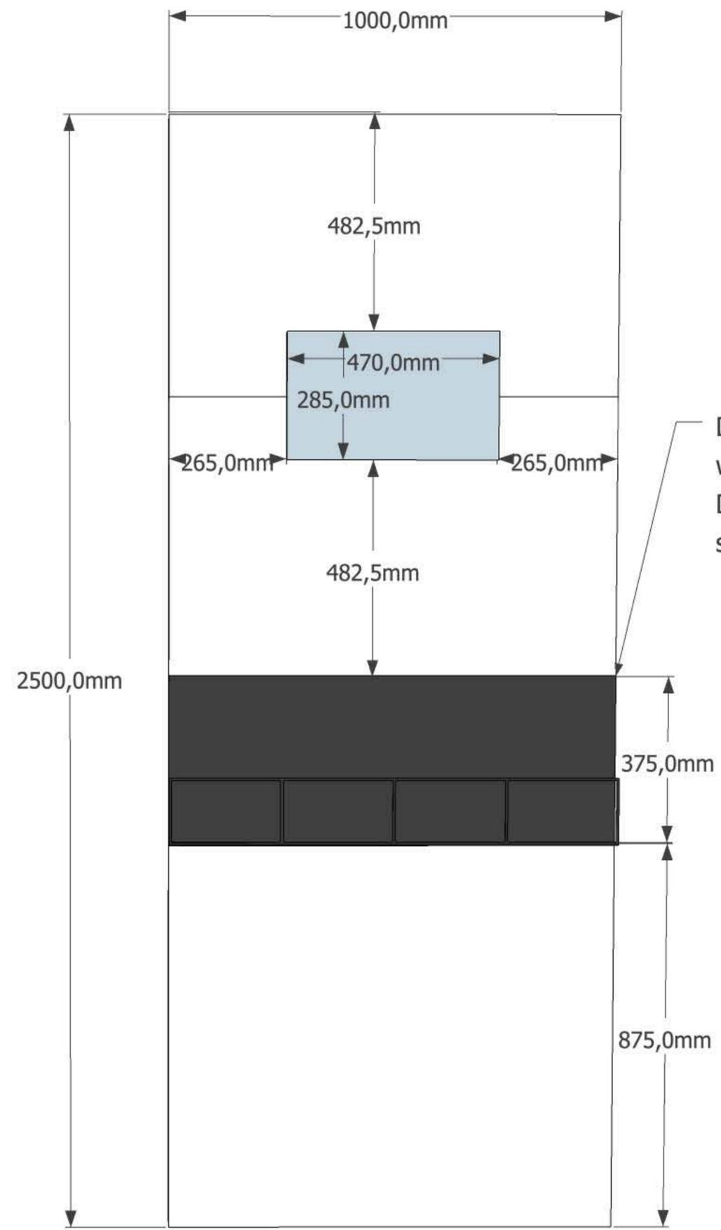
Das Paneel unter dem Prospekthalter wird um 50mm eingekürzt.
