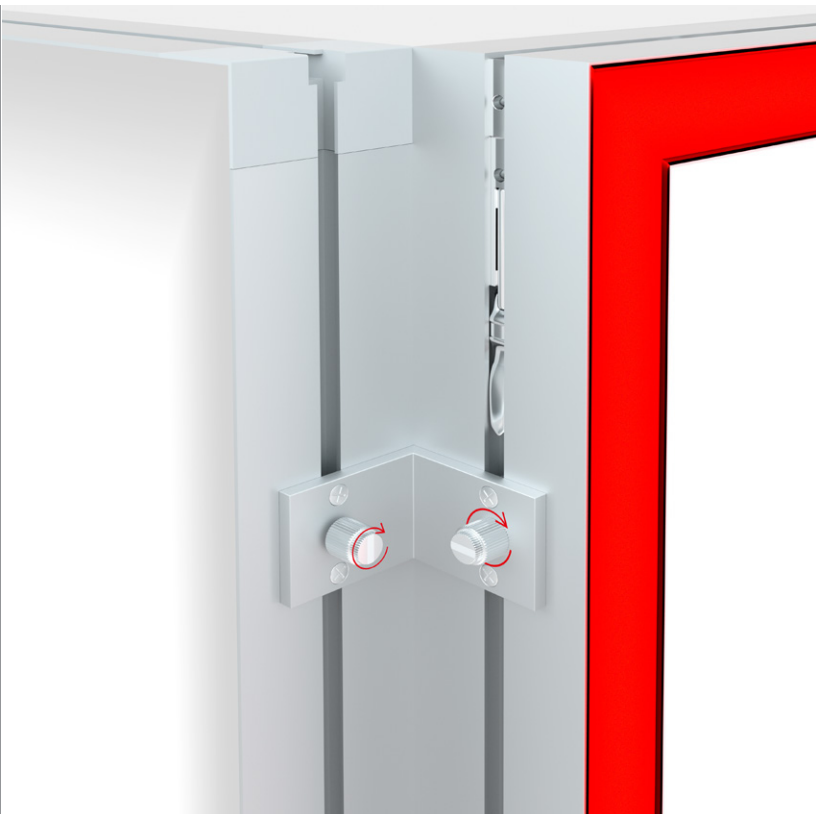
Eckverbindung Lightframe an Lightbox mit den 90° Verbinder. Die Rändelschraube drücken und um 90° drehen, so dass sie in die Nut einrastet und die Markierung waagrecht steht. Anschließend die Position mit der Rändelmutter fixieren. Corner connection lightframe to lightbox with 90° Connector. Press the knurled screw and turn it 90° so that it engages in the groove and the marking is horizontal. Then fix the position with the knurled nut.
