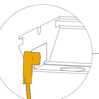
Das GO SPIRALKABEL 1380 muss mit den oberen und unteren GO LED-Profilen verbunden werden. | The GO SPRING CABLE 1380 must be connected to the upper and lower GO LED Profiles.
