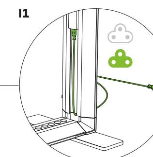
Während der Rahmenmontage den GERÄTSTECKER EU einsetzen und mit dem Netzteil verbinden. | During frame assembly, install the DEVICE PLUG EU and connect it to the power supply unit.
