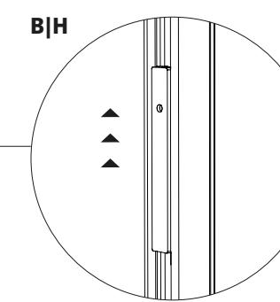
Auf der rechten Seite muss die Öffnung für den Netzteilanschluss (kleine Öffnung) nach oben ausgerichtet sein. | On the right side, the power supply connector opening (the small opening) must be positioned toward the top.
