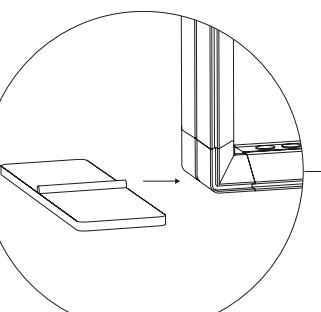
Unter die ECKVERBINDER oder STREBENHALTER platzieren, um Stabilität zu gewährleisten. | Place underneath the CORNER CONNECTORS or STRUT HOLDERS to ensure stability.
